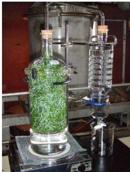
これは所要時間が1時間ほどで、蒸留が進む様子を目の前で見られるそう。かなりの葉をガラスの容器に詰め込んだが、1回の蒸留で4~5 mlしか採れないらしい。枝と葉から採れる精油と、葉だけの精油。どのような違いが生まれるのか期待せずにはられない。
