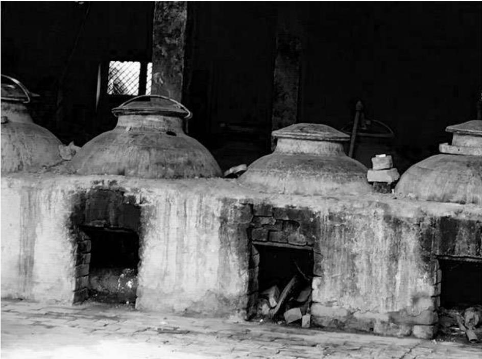
銅製の鍋から管を通して冷却水の中へ窯（上の写真の裏側から見た状態）
