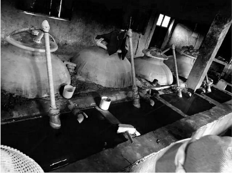
銅製の鍋から管を通して冷却水の中へ
