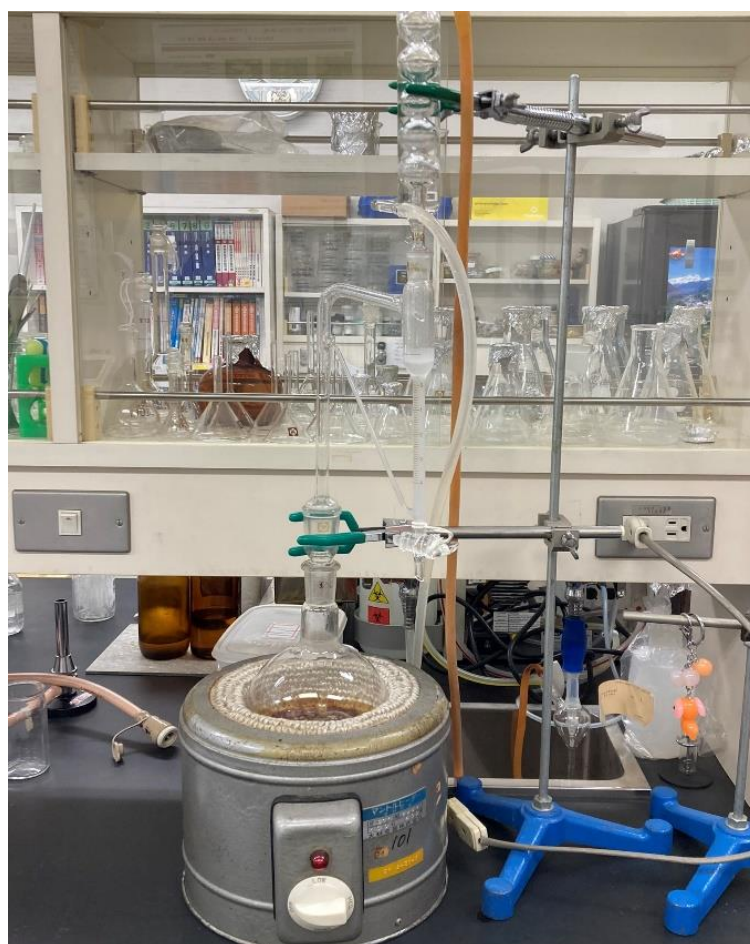
(精油定量装置。上部に還流冷却器が接続している)
